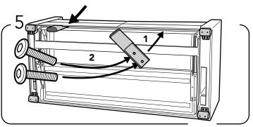
Installez le pied de support à la place indiquée, vissez les deux boulons (M6x25mm) dans les trous percés.
