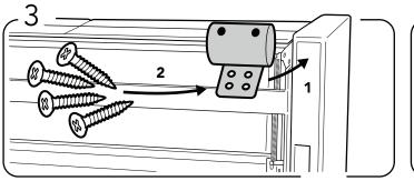
Installez le pied métallique sur place et vissez les quatre vis (3,5mmX25mm) dans les trous percés.
