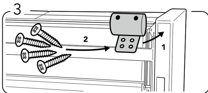
Instale la pata metálica en el lugar indicado y atornille cuatro tornillos (3,5mmX25mm) en los agujeros presentes.
