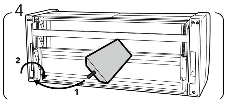
Instale las dos patas traseras girando cada una en dirección de las manecillas del reloj dentro de los cuatro agujeros presentes.
