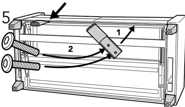
Instale la pata de soporte en el lugar indicado y atornille los dos pernos (M6X25mm) en los agujeros.
