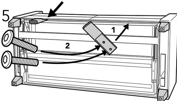
Installez le pied de support dans la place indiquée et vissez les deux boulons (M6X25mm) dans les trous percés.
