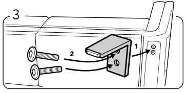
Installez le pied métallique sur place et vissez les deux boulons (M6x25mm) dans les trous percés.
