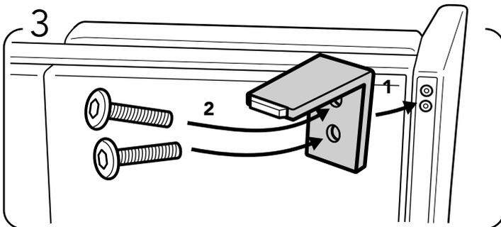
Instale la pata metálica en el lugar indicado y atornille los dos pernos (M6x25mm) en los agujeros presentes.
