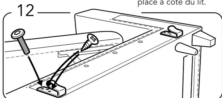
Installez les deux ancrages avec les boulons M6x20mm et les vis 15mm, comme il est illustré à l'image. Mettez le boulon dans le trou supérieur et les vis dans les autres trous. Ne pas les serrer excessivement!
