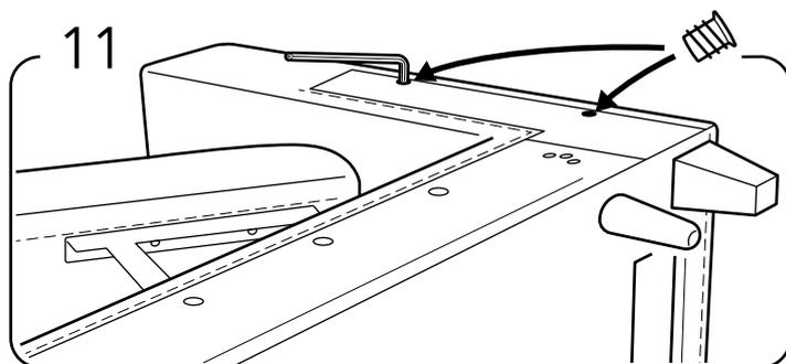
Tournez le divan vers la place de l'accoudoir et vissez les deux écrous à vis. Ne pas les serrer excessivement!
