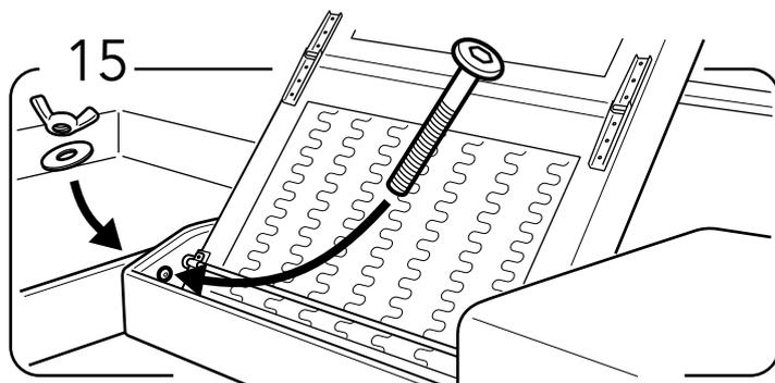
Soulevez le lit et attachez le lit au front avec le jeu boulon-écrou à ailettes.
