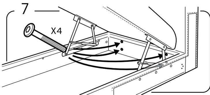
Maintenant, soulevez la partie ouvrable du divan et fixez la partie postérieure avec quatre boulons (M6x50mm).
