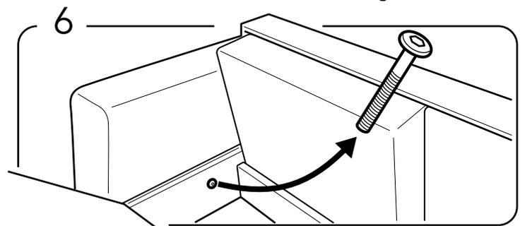
6 — Soulevez la partie arrière du lit et retirez le dernier boulon de fixation.
