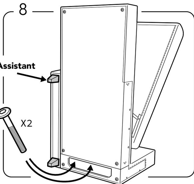
Tournez le divan en arrière et laissez que la partie adjointe soulève l'accoudoir comme l'image illustre. Fixez l'accoudoir à la partie arrière de l'intérieur de la charpente avec les deux boulons qui ont été retirés antérieurement.
