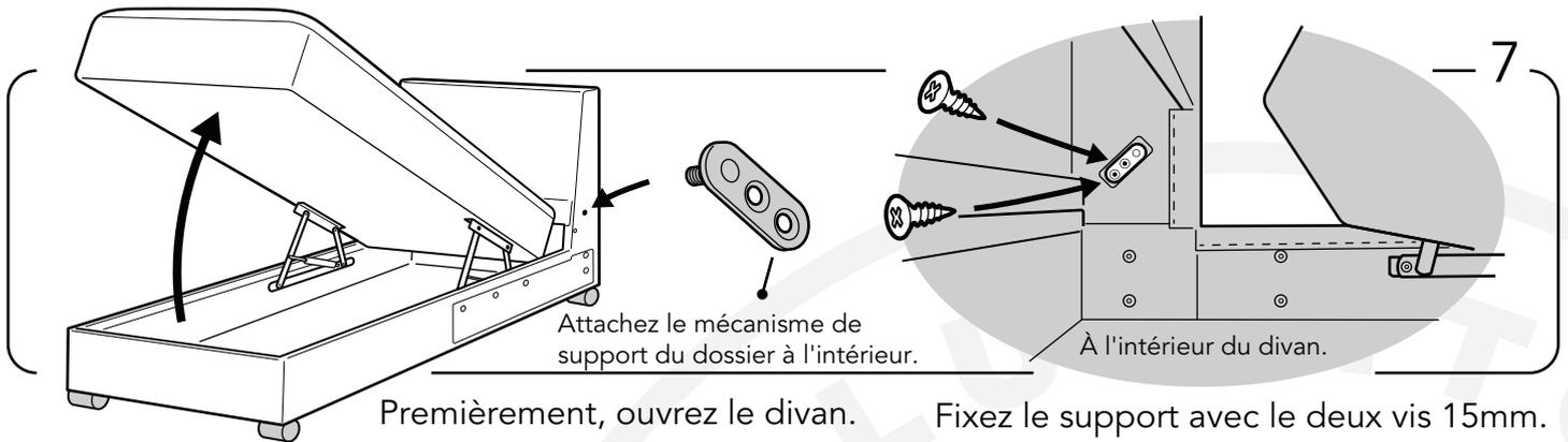
Attachez le mécanisme de support du dossier à l'intérieur.
