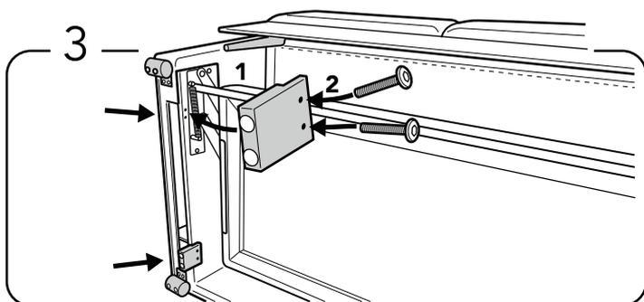
Installez les pieds de support sur place et vissez les deux boulons (M6X25mm) dans les trous percés.
