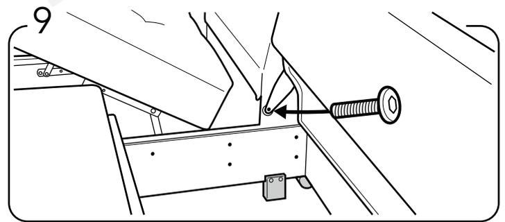
Attachez le dossier du canapé au divan (n'oubliez pas d'utiliser les deux rondelles entre l'écrou et le boulon).
