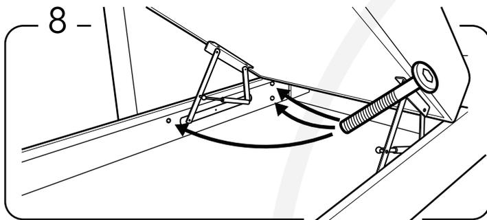
Fixez l'accoudoir avec 3 boulons, montez un des boulons face avant et les autres deux par l'arrière.
