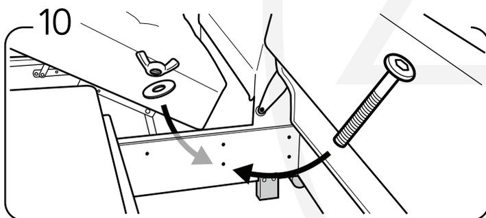
Montez le lit sur le diván abatible en utilisant un jeu de boulon à l'arrière.
