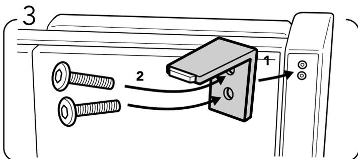
Installez le pied métallique sur place et vissez les deux boulons (M6X25mm) dans les trous percés.
