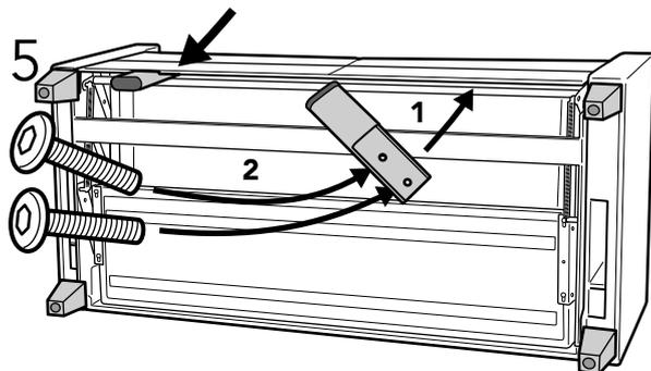
Installez le pied du support sur place et vissez les deux boulons (M6x25mm) dans les trous percés.
