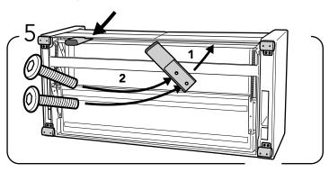
Installez le pied du support sur place et vissez les deux boulons (M6x25mm) dans les trous percés.
