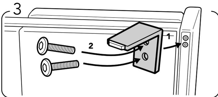
3 — Instale la pata metálica y atornille los dos pernos (M6X25mm) en los agujeros presentes.
