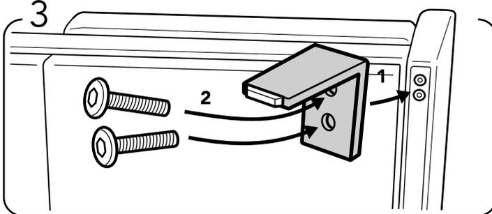
Installez le pied métallique et vissez les deux boulons (M6X25mm) dans les trous percés.
