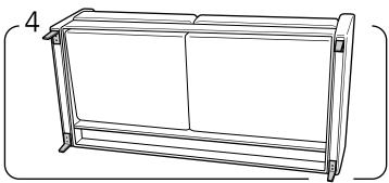
Instale la pata metálica y atornille los dos pernos (M6X25mm) en los agujeros presentes.
