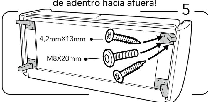
Una cada pata con el perno M8x25mm para alinear la placa de metal en su lugar y luego use dos tornillos de madera para cada pata.
