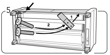
Installez le pied de support dans la place indiquée et vissez les deux boulons (M6X25mm) dans les trous percés.
