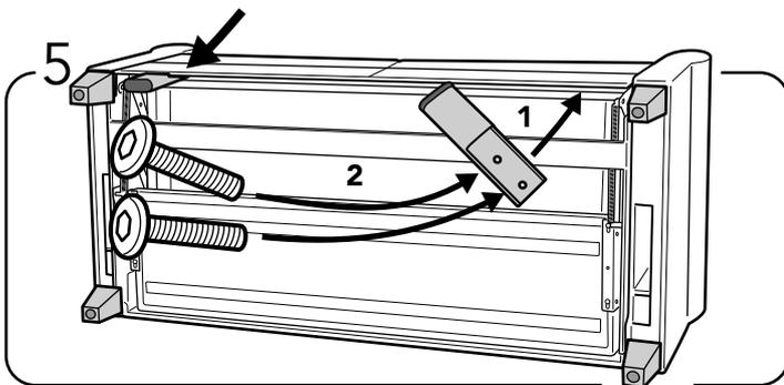
5 — Instale la pata de soporte en el lugar indicado y atornille los dos pernos (M6X25mm) en los agujeros.
