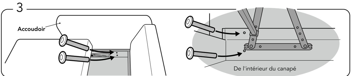
Attachez la charpente du canapé aux accoudoirs à droite et à gauche avec quatre boulons (M6x50mm) à chaque côté.
